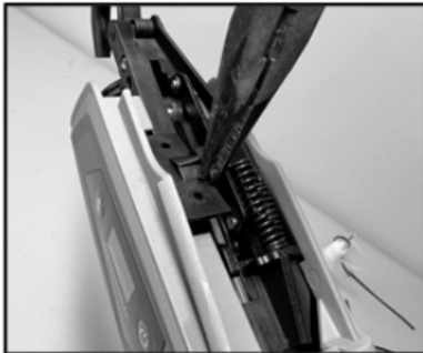
4. Retire la placa de cubierta izquierda
