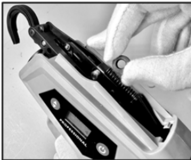
7. Reemplace la correa de goma por una nueva. Asegúrese de que la ranura de la misma quede hacia afuera.
