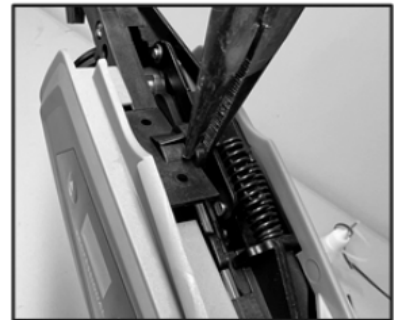
9. Instale la placa de cubierta izquierda
