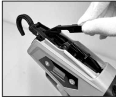
2. Retire la placa de sujeción.
